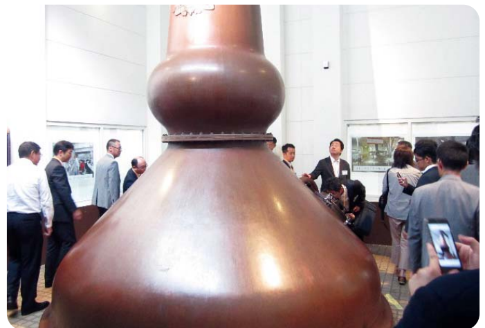
キリンディスティラリー ポットスチル(モルトウイスキー蒸溜器)
